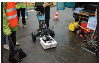
Figura 1. Indagini-georadar (ENVIA, Studio Associato di Geologia e Geofisica, Bologna).
