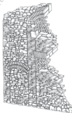
Figura 21 – Atesa (Ch), chiesa di S. Giusta (chiesa superiore), apparecchio murario in laterizio del prospetto settentrionale, databile tra il XV e il XVI secolo.
