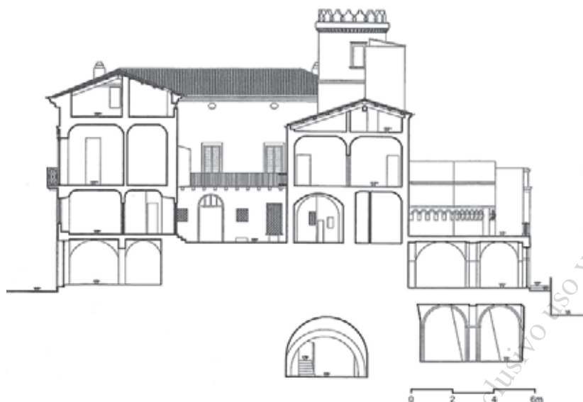
Figura 25 – Vasto (Ch), sezione trasversale del castello (disegno di G. Naccarella, ALabRes, 2008).
