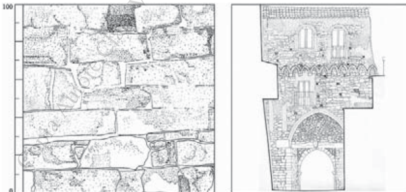
Figura 1 – Atessa (Ch), Porta S. Giuseppe, apparecchio murario in blocchi di arenaria e scaglie lapidee a corsi sub orizzontali.
