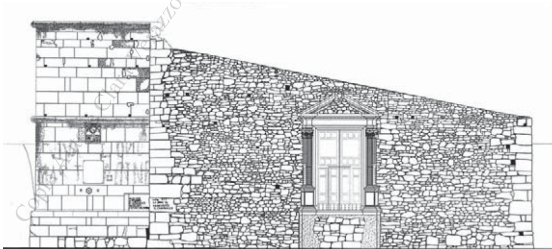
Figura 40 – Taranta Peligna (Ch), chiesa di S. Biagio, prospetto principale con apparecchio murario in bozze di dimensioni variabili a corsi sub-orizzontali (disegno di A. Lanutti, ALabRes, 2003).
