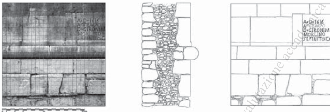
Figura 53 – Taranta Peligna (Ch), chiesa di S. Biagio, rilievo del paramento murario del campanile in conci a corsi orizzontali e paralleli.
