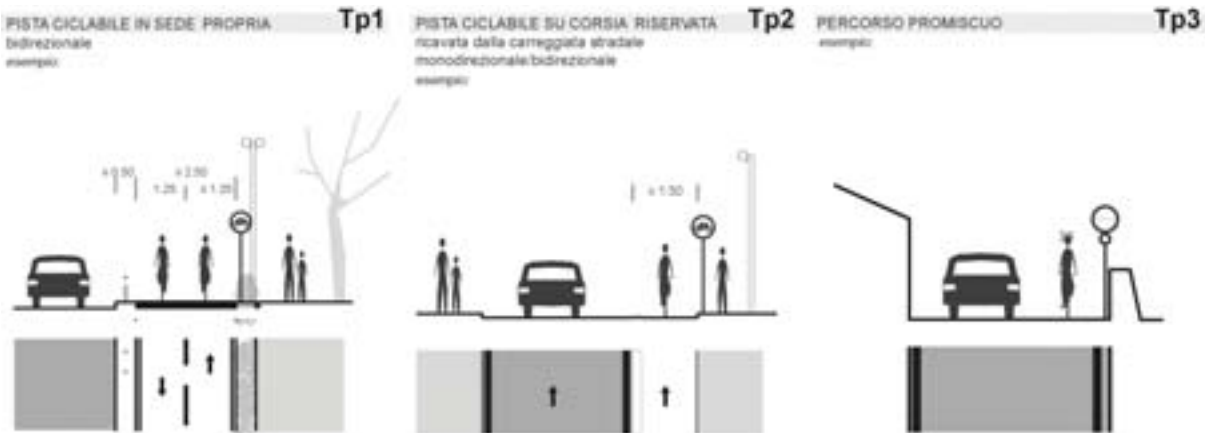
Fig. 21. Soluzioni tecniche associate alle diverse tipologie di tracciato.
