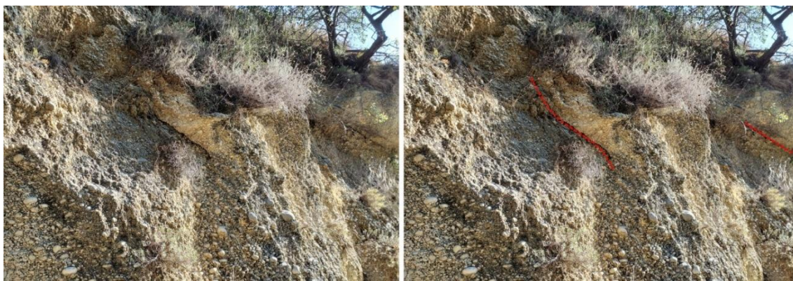
Figura 172. Parete sub-verticale con direzione nord-est impostata sui conglomerati in affioramento nell'area, settore centro-meridionale dell'area di studio (290 m s.l.m.). Presente sistema di fratture con direzione N045E ed immergenti di 60 gradi verso nord-ovest (indicate dalle linee rosse a tratteggio nella figura di destra); tali fratture si presentano da serrate ad aperte, con apertura massima intorno ai 3 cm. Foto scattata verso SSO.
