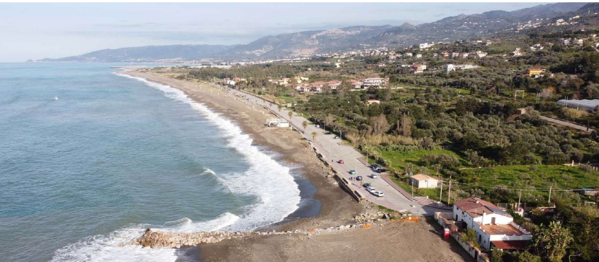
Fig. 00 Vista aerea di un tratto del litorale di Acquedolci (ME). L'occupazione della spiaggia con opere di urbanizzazione e il blocco del trasporto solido causato dal pennello posto soprattutto hanno esposto la strada agli effetti delle mareggiate. Foto dell'Osservatorio di Messina
