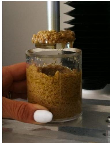
Figura 4.5. Prova di estrusione di ritorno (a–d), fasi operative principali con un campione di pat  di olive.
