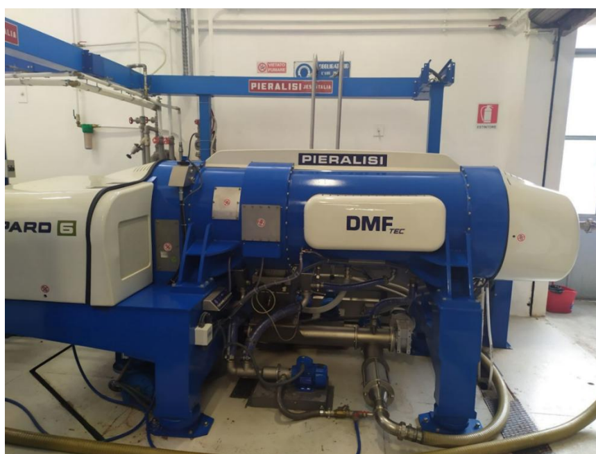
Figura 3.1. Decanter multifase della serie Leopard DMF.
