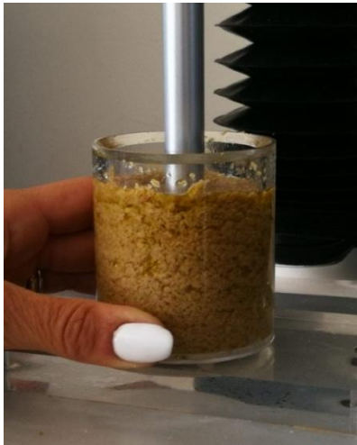
Figura 4.5. Prova di estrusione di ritorno (a–d), fasi operative principali con un campione di pat  di olive.
