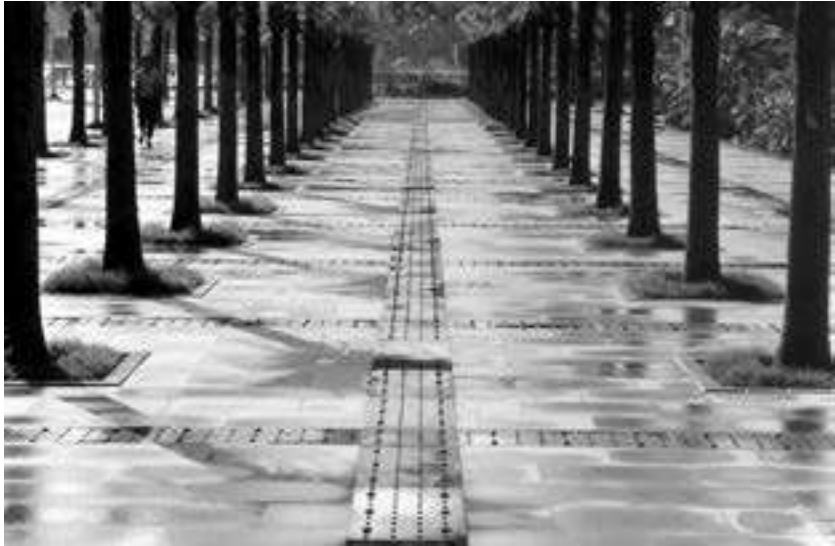
8. Una piazza alberata consente la fruizione dello spazio collettivo urbano anche in un clima tropicale, la pavimentazione è in pietra con listature in elementi metallici riciclati. (foto Turenscape)
