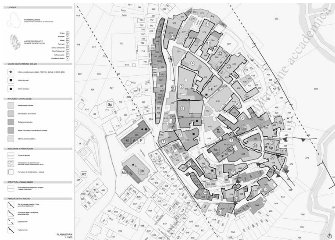
Figura 17 – Castel di Ieri (Aq), Carta delle tipologie di intervento del Piano di Ricostruzione. La permanenza di manufatti ridotti a rudere a seguito del terremoto marsicano caratterizza sia l’ambito n. 5 Pestevole , sia l’ambito n. 7 Fienili .
