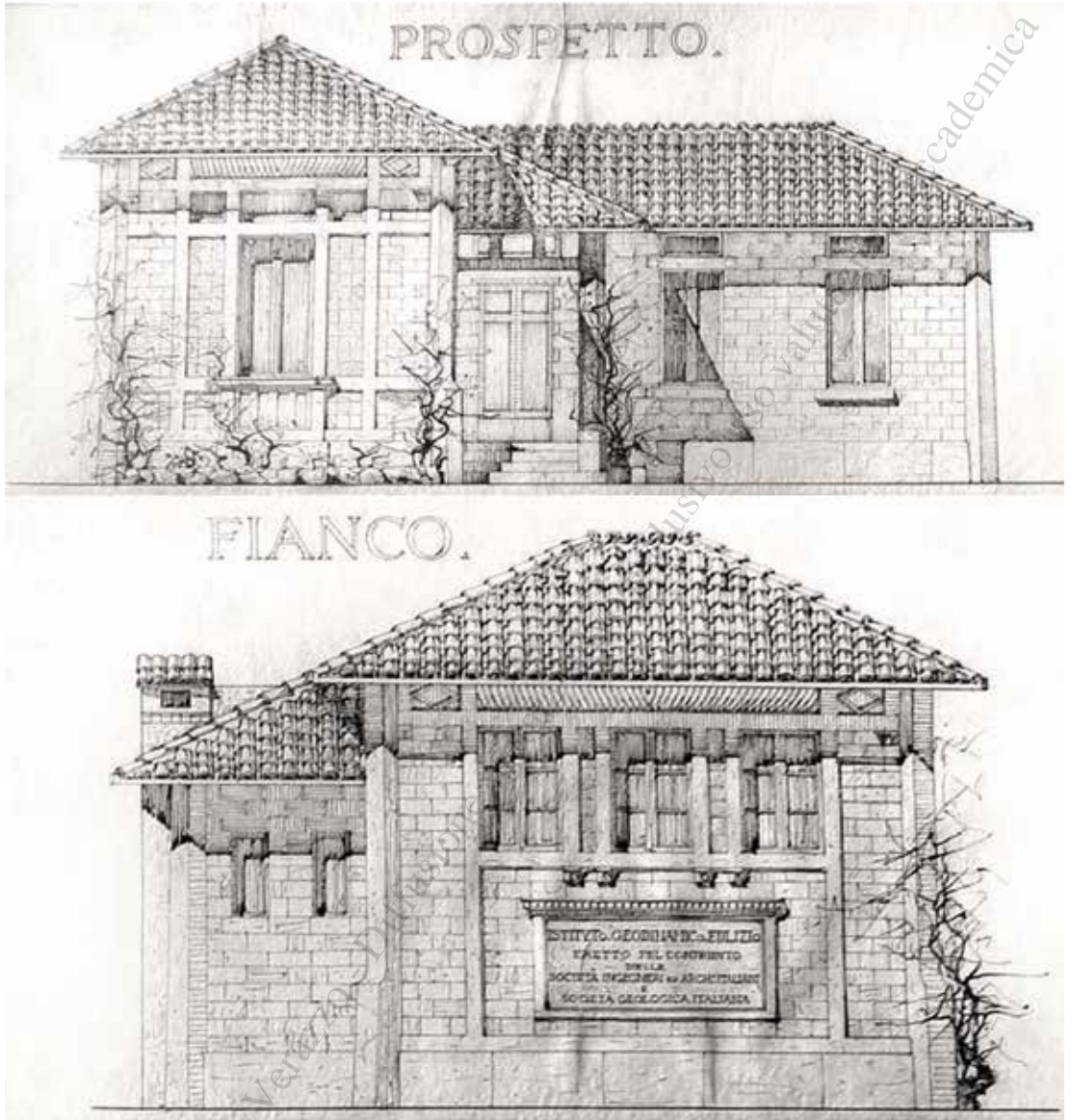
Figura 14 – Gustavo Giovannoni , Prospetti principale e laterale, Istituto geodinamico edilizio ad Avezzano, 1916 ( CENTRO DI STUDI PER LA STORIA DELL'ARCHITETTURA , 2018, op. cit. , p. 90)
