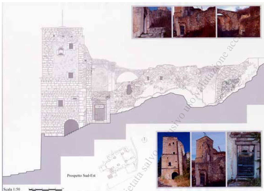
Figura 30 – Pescina (Aq), prospetto sud-orientale della chiesa di San Berardo. Il rilievo evidenzia i lacerti murari dei muri perimetrali e del campanile a seguito delle demolizioni degli anni Cinquanta (disegno di P. Di Nino, A LabRes, 2007).
