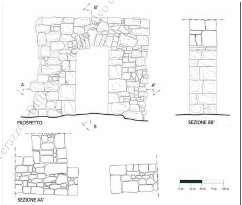
Figura 10 – Morino (Aq), palazzo Facchini, rilievo dell'apertura in blocchi, bozze e scaglie lapidee con del prospetto occidentale (disegno di W. Battista, D. Capitanio, ALabRes, 2015).
