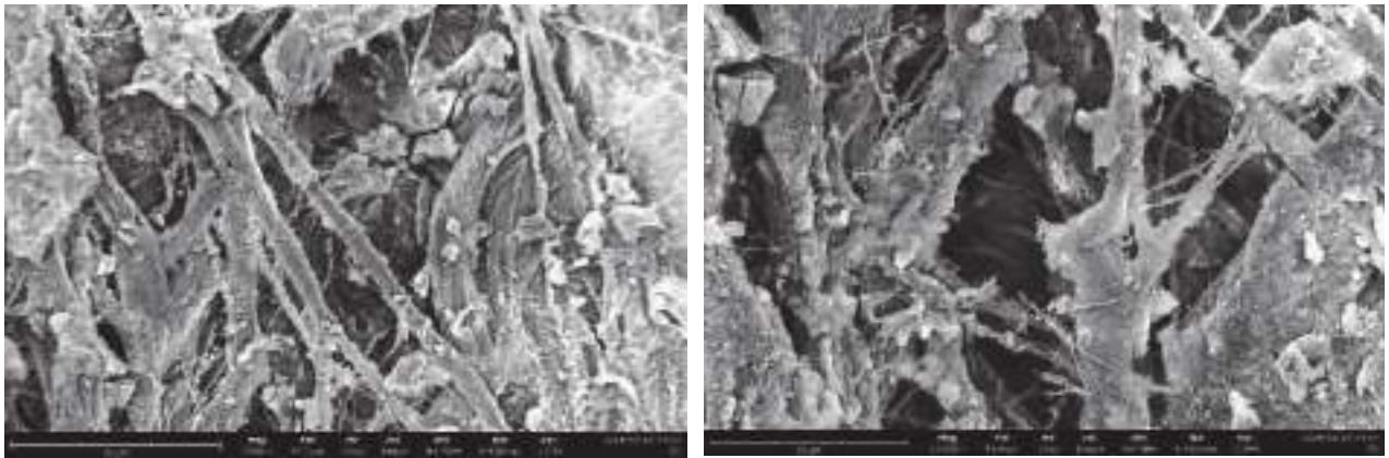
Figura 41. Immagini SEM dei campioni ottenuti dai test di adesione tramite gocciolamento, immersione, bar-coating e filtrazione con sola acqua
