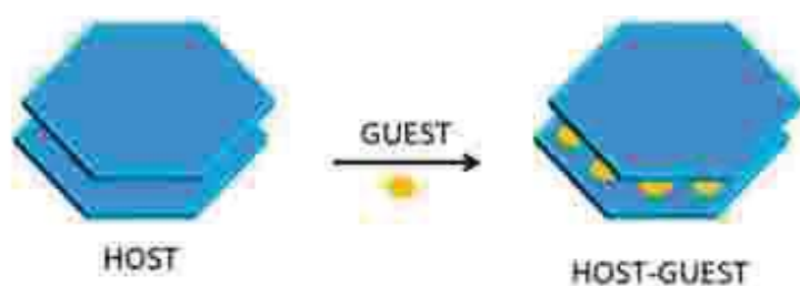
Figura 18. Schema di un processo di intercalazione in un idrotalcite [88]
