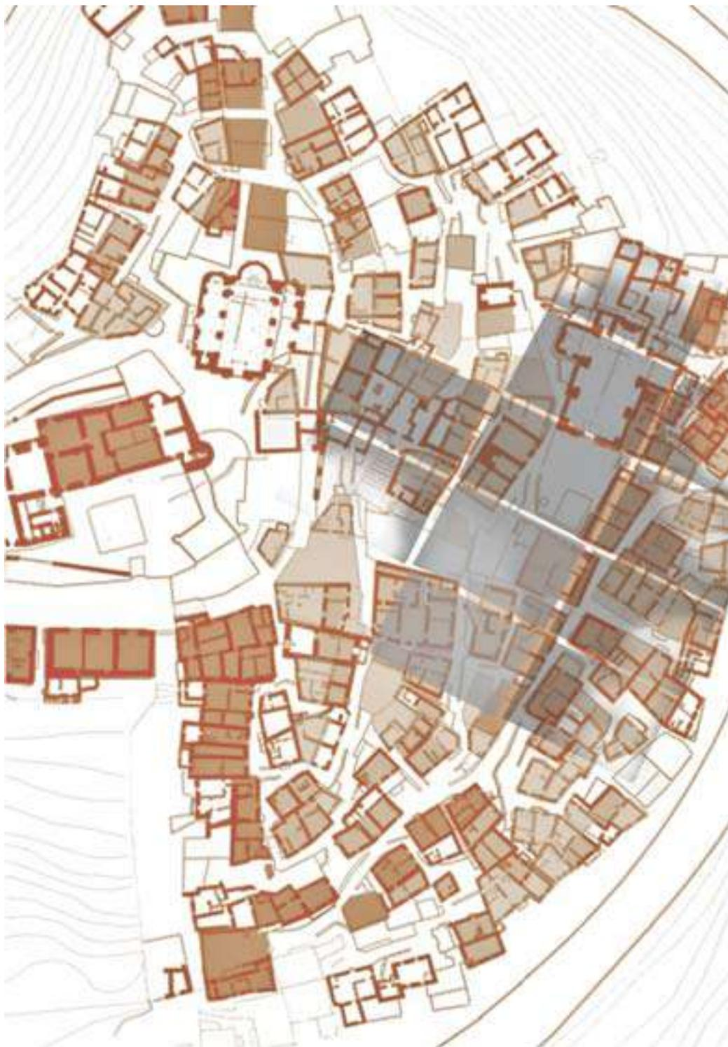
San Vito Romano: esame delle orditure dei maschi murari e delle principali strutture verticali lasciano ipotizzare un primitivo disegno fondiario, del tipo a corte, sostrato del tessuto edilizio (in grigio).
