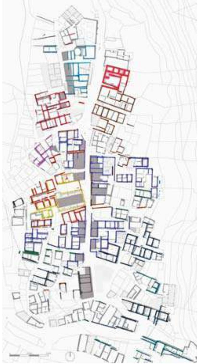
Bellegra (ex Civitella) Analisi della morfologia dell'aggregato storico. a-b) Fasce di pertinenza delle fasi più antiche; c-d) Fasce di pertinenza delle fasi più moderne.
