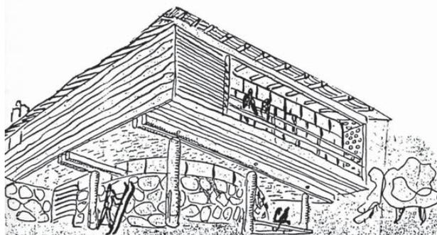
stinzione tra la parte basamentale in pietra e la parte superiore costituita da un leggero telaio in legno, la flessibilità ed adattabilità degli interni, la divisione funzionale degli stessi, le semplici regole di aggregazione ed ampliamento ed i sistemi costruttivi.
