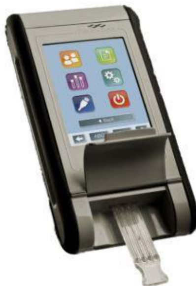
Figura 11: sistema portatile Endosafe Portable Test System (PTS) della Charles River.
