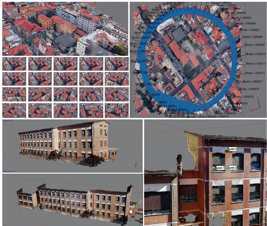
Fig. 3. Rilevamenti integrati con drone reale e virtuale Istituto scolastico via Milano (2019).
