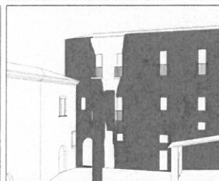
MACROELEMENTO: Facciata Palazzo Castellato MECCANISMO: Sporcimento della parete per effetto della spinta dell'arco di sbalzo
