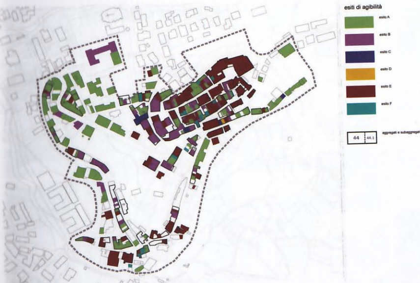
Rilievo dei danni (Bussi sul Tirino)
