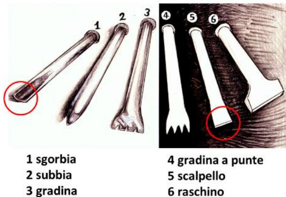
Fig. 32 Strumenti a percussione indiretta per la lavorazione della pietra.
